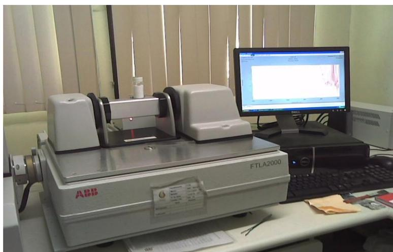
**Figura 7:** Espectrofotômetro NIR, modelo ABB BOMEM , e acessório *Powder Samplir*.
