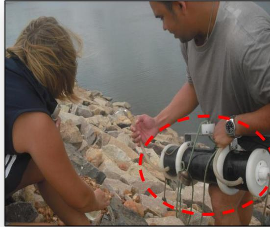
Figura 26: Garrafa de Van Dorn usada para coleta de água em profundidade.
