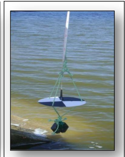
Figura 30: disco de Secchi para medição *in situ* da transparência da água.
