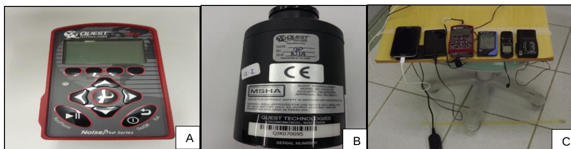
Figura 1 - A- Decibelímetro, B- Calibrador, C- Posicionamento dos dispositivos.
