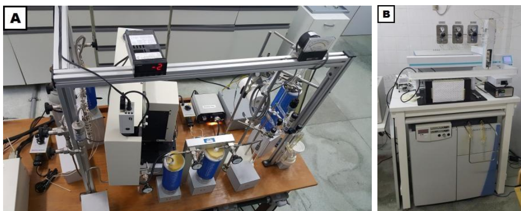
Figura 1.7.3.1: A) Linha de extração de oxigênio a laser de \text{CO}_2 do laboratório NEG-LABISE. B) Espectrômetro de massa modelo Thermofinnigan Delta V Advantage.
