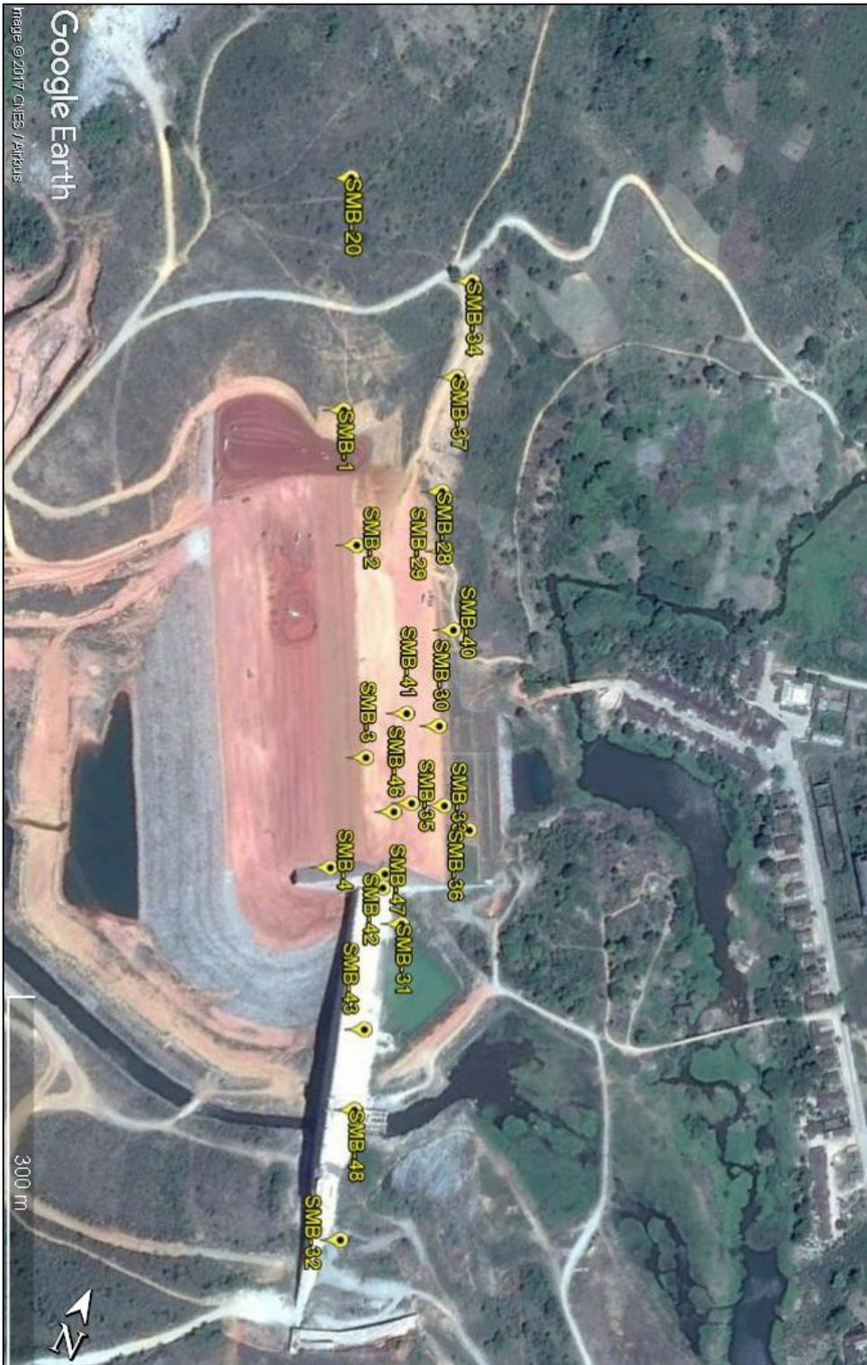
**Figura 11.** Localização das sondagens analisadas com relação ao eixo definitivo da Barragem Governador Eduardo Henrique Accioly Campos. Notar pequena rotação ( $10^\circ$ ) do abraço de terra no sentido de montante.
