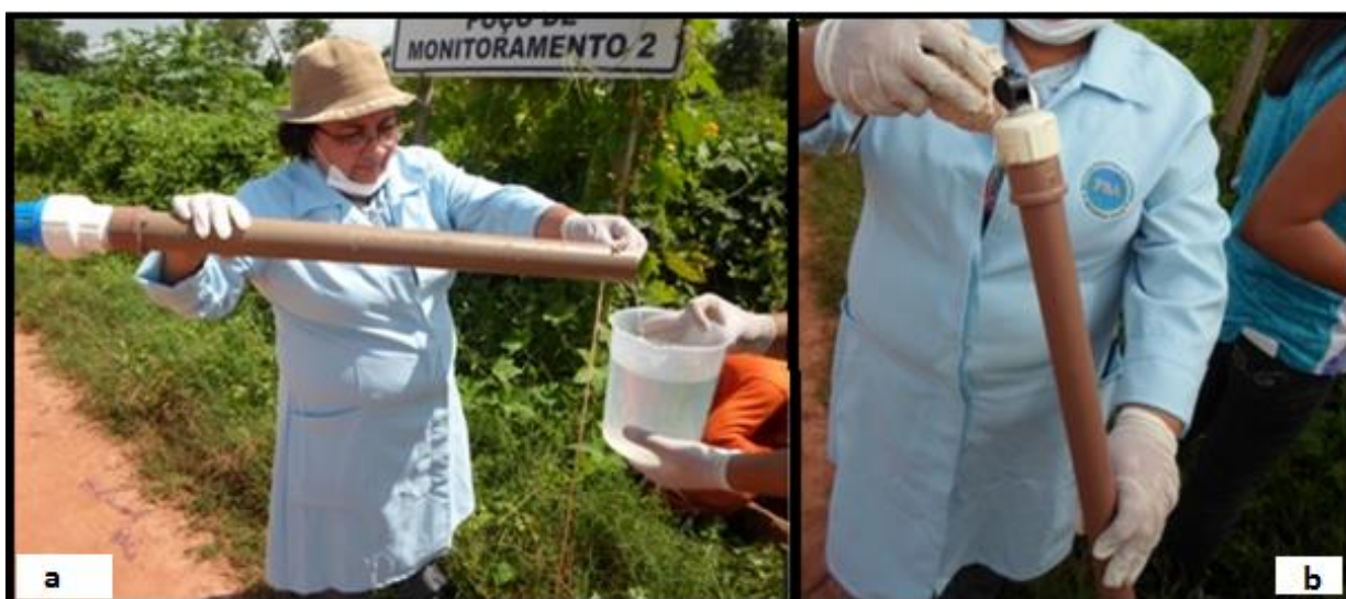
Fotografia 7 – Imagens da coleta de águas subterrâneas: a) procedimentos de amostragem de água; b) procedimentos de medição do nível freático dos poços
