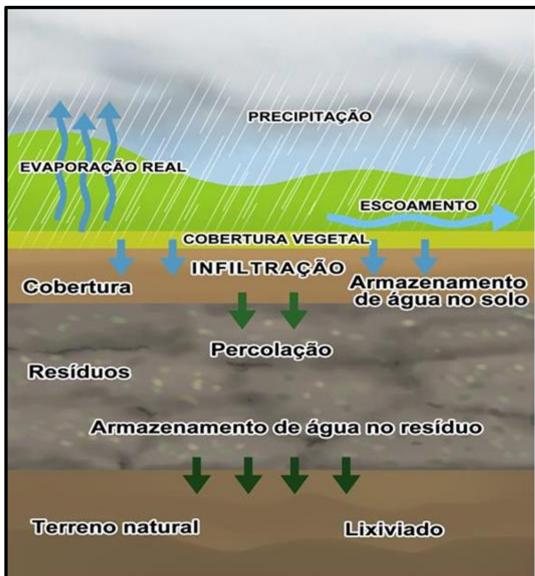
Figura 3 - Representação da distribuição da água da chuva em áreas de disposição de resíduos sólidos
