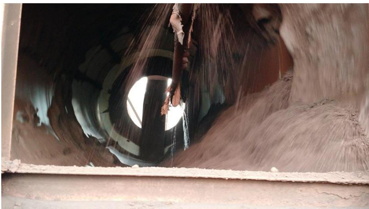
*Figura 2.8 - Misturador adicionando água para formar micro pelotas
