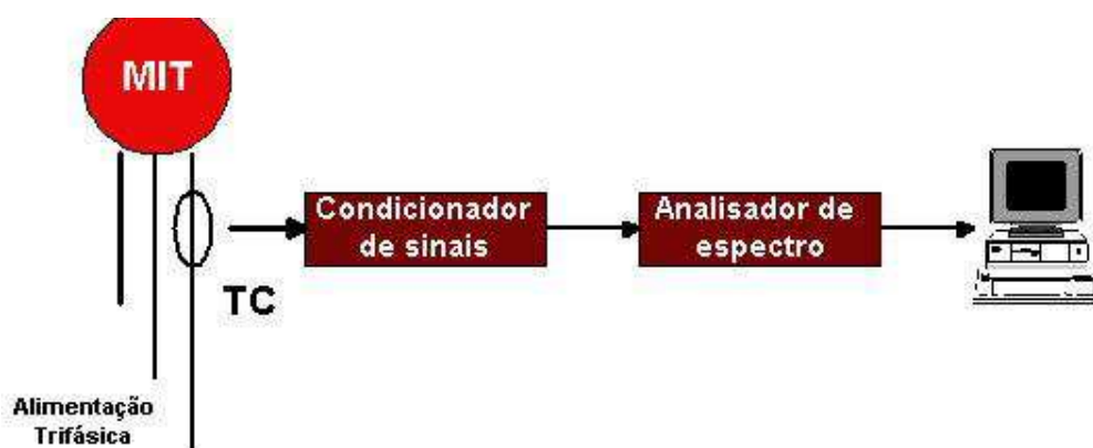
Figura 19 - Sistema típico para análise espectral da corrente de um motor de indução trifásico
