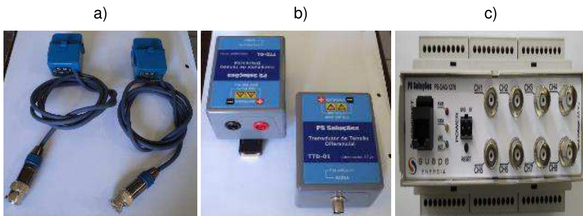
Figura 25 - Equipamentos de transdução e aquisição de sinais. a) Transformador de corrente, b) Transformador de tensão e c) Sistema de aquisição de dados
