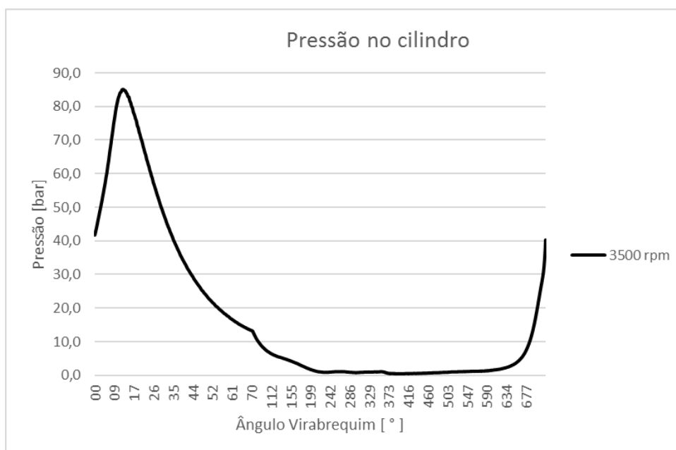
Figura 62 – Curva de pressão do motor EtorQ EVO 1.8l para a rotação de 3500rpm
