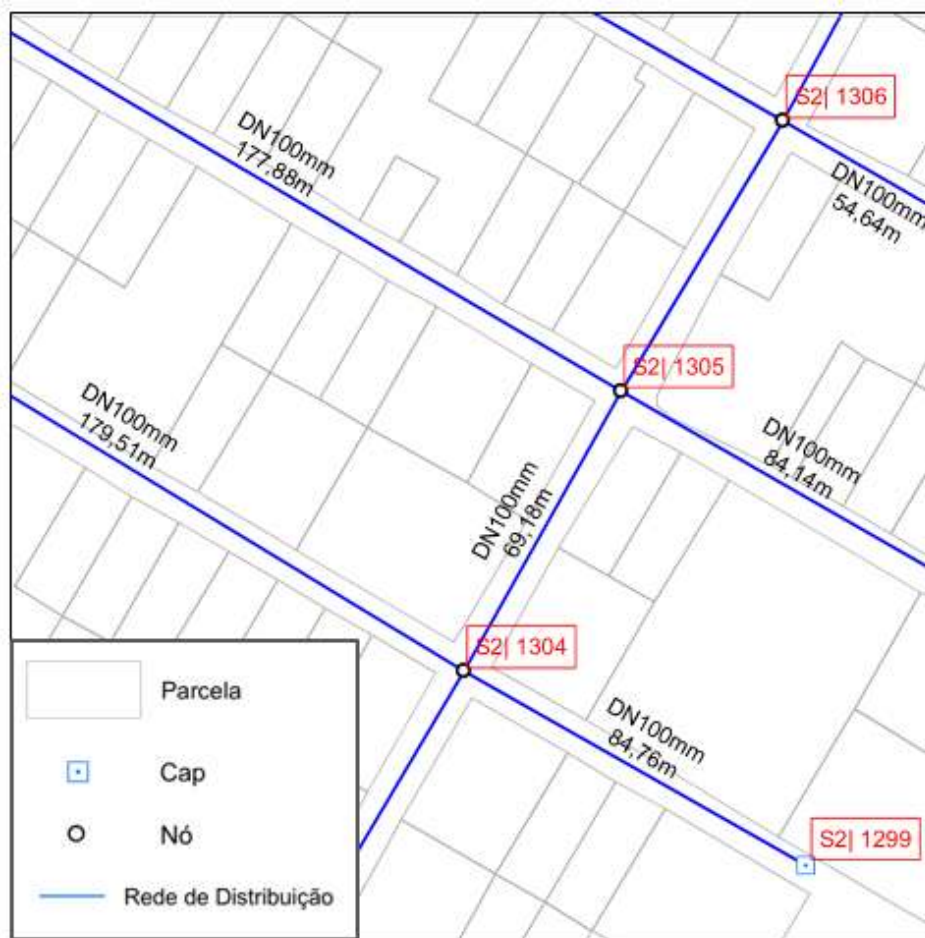
Figura 03: Planta da Rede de distribuição de água apresentada nos projetos de concepção.
