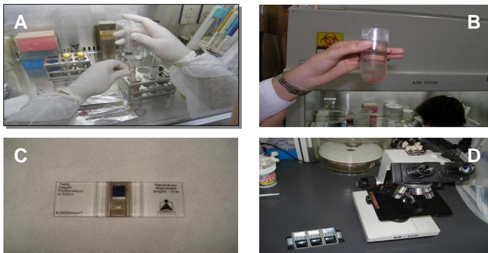
**Figura 11.** Equipamentos empregados para contagem de células-tronco: A - Tubo Falcon estéril contendo suspensão do aspirado medular com Heparina 1:10 em PBS 0,1 M, pH 7,2; B – *Pellet* de células-tronco separadas após centrifugação; C - Câmara de Neubauer para contagem de células D - Microscópio óptico com condensador dicrótico e contador para contagem das células
