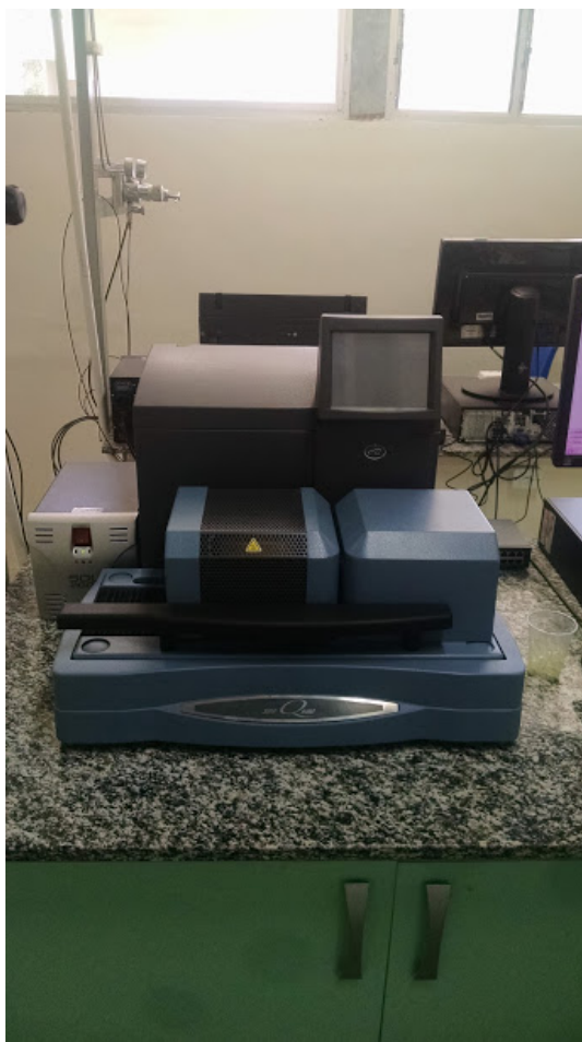
Figura 7 – Analisador termogravimétrico e calorímetro simultâneo SDT-Q600, ta instrumentos TM .
