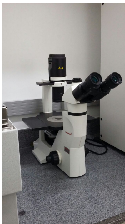
Figura 13 – Microscópio invertido - TCM400, LABOMED™, utilizado para avaliação e contagem das células na câmara de Neubauer.
