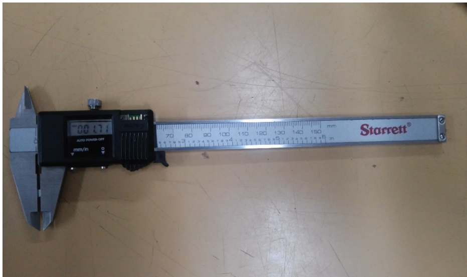
Figura 5 – Paquímetro digital Starrett TM 150 mm utilizado para aferição das amostras.
