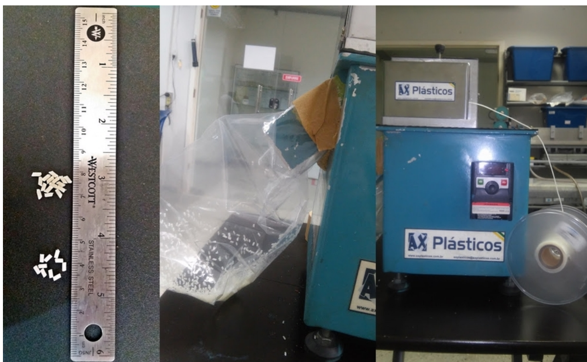
Figura 4 – Preparação das amostras. Fragmentação utilizando uma granuladora de polímeros.
