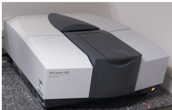
Figura 8 – Espectrofotômetro de FTIR IRTracer-100 utilizado para caracterização das amostras.
