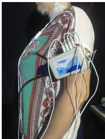
Figura 5 - Sistema de aquisição de atividade elétrica dos músculos preso ao braço do participante
