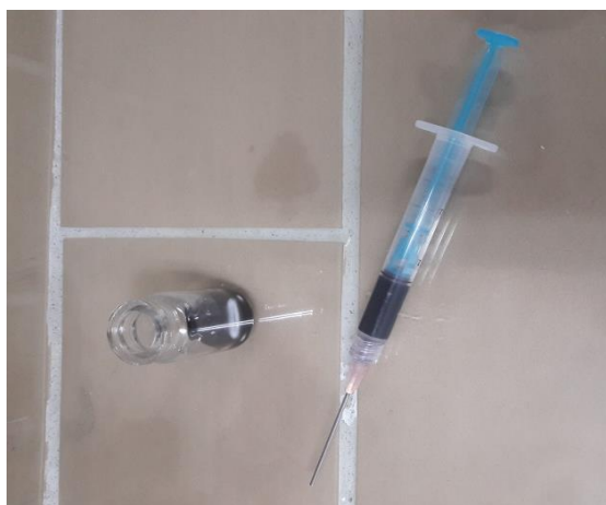
Figura 28. Coleta do material, através de uma agulha para o processo de eletrofiação.
