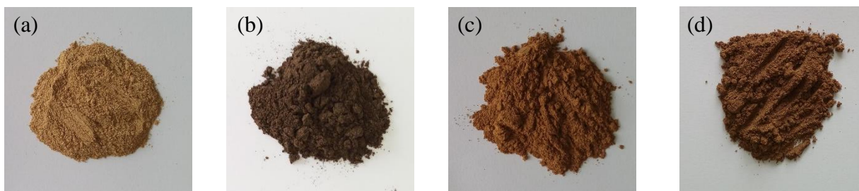
Figura 2 - Lodo galvânico (LG) com classificação de 80 mesh ( < 0,18 mm): (a) LG - IN, (b) LG - 250, (c) LG - 400 e (d) LG - 900.
