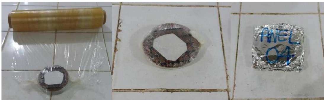
Foto 7: Processo de isolamento dos anéis
