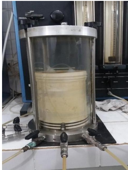
Foto 3: Câmara de acrílico contendo amostra no momento da realização do ensaio de permeabilidade a água.
