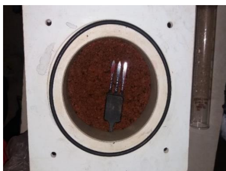
Foto 10: Detalhe do sensor dentro da coluna.
