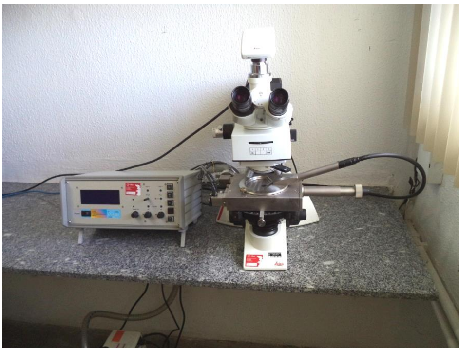
Figura 3 – Microscópio petrográfico modelo Zeiss/Axio Scope A1, com o equipamento de catodoluminescência acoplado, modelo MK5 fabricado pela empresa CITL - Cambridge Tech.
