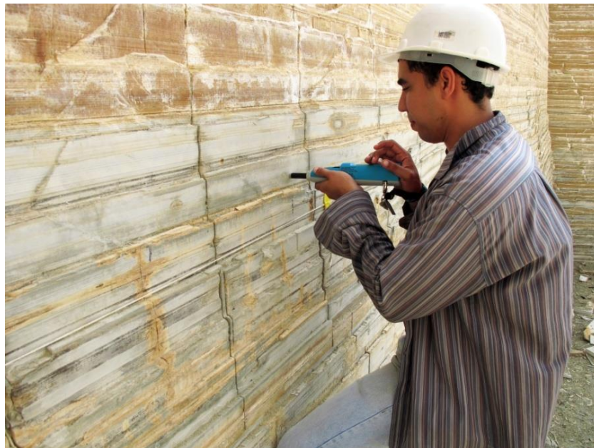
Figura 5 – Utilização de um esclerômetro para a realização de uma leitura, efetuada por meio do impacto do embolo na superfície da rocha, em um perfil vertical.
