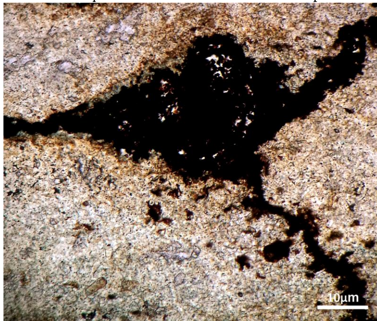
Figura 35 – Fotomicrografia a nicóis paralelos destacando aspectos da matriz micrítica de laminito bege. Detalhe de uma zona de dissolução da matriz micrítica, onde também ocorreu a precipitação de óxido de ferro que substituiu a matriz e cristais de pirita.
