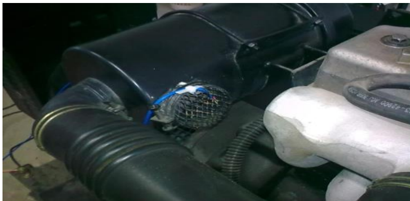
FIGURA 13 – Instalação do termopar tipo T- entrada de ar do sistema de combustão.
