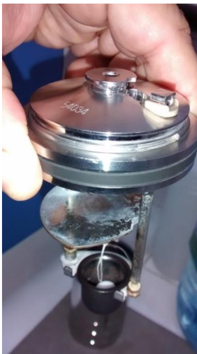
FIGURA 7 – Bomba calorimétrica – Vaso de decomposição
