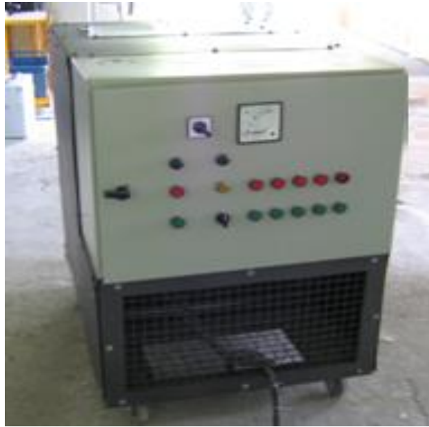
FIGURA 28 – Banco de resistor trifásico.
