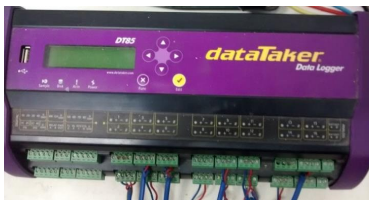
FIGURA 15 – Conexão dos termopares ao DATA TAKER DT85.
