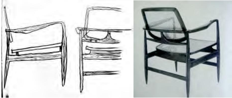
**Fig. 37 e 38** // croqui e foto da Poltroninha Jockey, em madeira esculpida com assento e encosto em palhinha de Málaca. Os braços são esculpidos em peça única. 1957, Sérgio Rodrigues (Módulo nº29, 1962).
