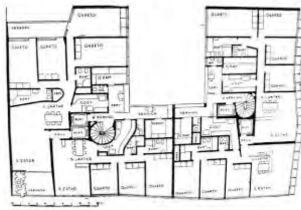
Fig. 22 e 23 // Edifício com paredes curvas, de filiação modernista, acaba por gerar modificação na planta e fachada. (Habitat nº 26, janeiro de 1956, edifício de apartamentos em Copacabana).
