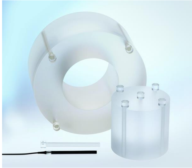
Figura 8 – Exemplo de phantoms cilíndricos de cabeça e de tronco e câmara de ionização do tipo lápis utilizadas para estimativa de dose em TC.
