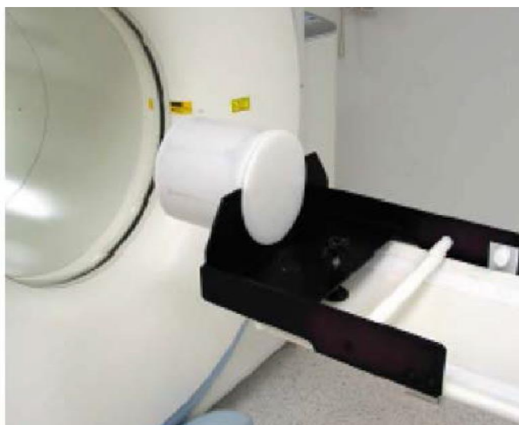
Figura 4 – Exemplo de phantom , contendo fonte de ^{68}\text{Ge} , colocado em suporte para teste de CQ.
