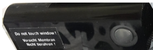
Figura 12 - Câmara de ionização PTW W23342 número de série 1090
