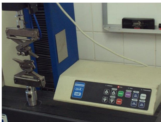
Figura 6 – Máquina de ensaio biomecânico (EMIC, Modelo DL 500, Brasil). Fonte: Arquivo pessoal.
