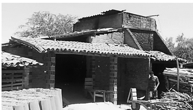
Figura 13 - Forno de queima de tijolos, telhas e demais produtos cerâmicos: 1 – vista anterior do forno, com área lateral de depósito e de lenha (abertura da fornalha anterior); 2– vista lateral do forno, com paredes de sustentação (abertura da fornalha posterior); 3 – vista da fornalha anterior, com cinzeiro para retirada das cinzas, fechado com tijolos
