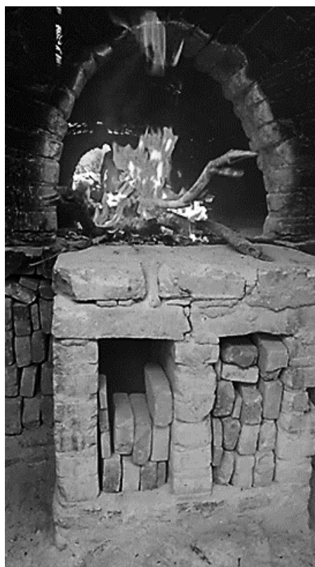
Figura 13 - Forno de queima de tijolos, telhas e demais produtos cerâmicos: 1 – vista anterior do forno, com área lateral de depósito e de lenha (abertura da fornalha anterior); 2– vista lateral do forno, com paredes de sustentação (abertura da fornalha posterior); 3 – vista da fornalha anterior, com cinzeiro para retirada das cinzas, fechado com tijolos
