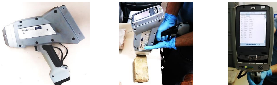
Figura 25 - Aparelho de fluorescência de raios X.
