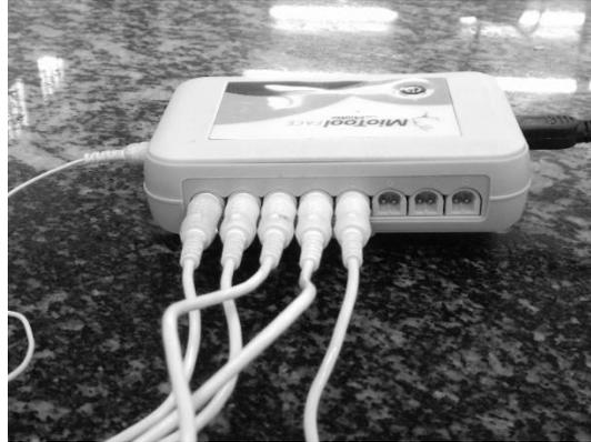
Figura 2 - Equipamento EMGs
