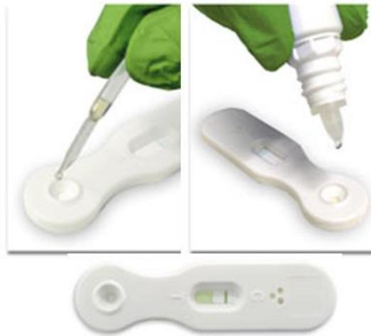
Com auxílio de uma pipeta, uma gota da amostra de urina é colocada no recipiente circular; em seguida, o tampão é colocado, e após 20 minutos aparecerão duas faixas rosa, caso a amostra seja positiva; caso contrário, apenas a faixa rosa controle irá aparecer.
