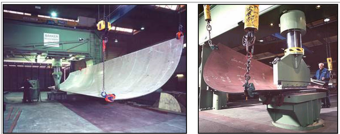
Figura 7: curvatura de chapas por prensas hidráulicas.
