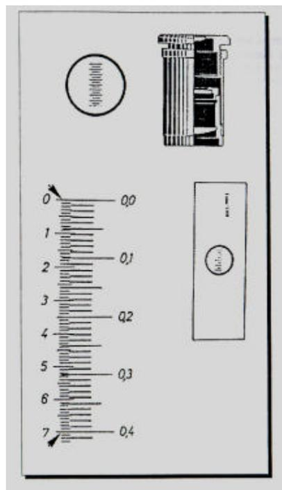
**Figura 12.** Micrômetro ocular no alto e micrômetro objeto à direita em baixo. A escala que se coloca no interior do micrômetro ocular (esquerda no alto) deve ser superposta ao micrômetro objeto para conhecer o aumento (esquerda embaixo).
