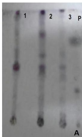
Figura 6. Cromatograma do extrato hexânico de *Tarenaya spinosa* para detecção de terpenos. 1 = caule, 2 = folha, 3 = flor, P = extrato clorofórmico de *Mesosphaerum suaveolens* (alfavaca de cabloco). Fase móvel e revelador conforme Tabela 1.
