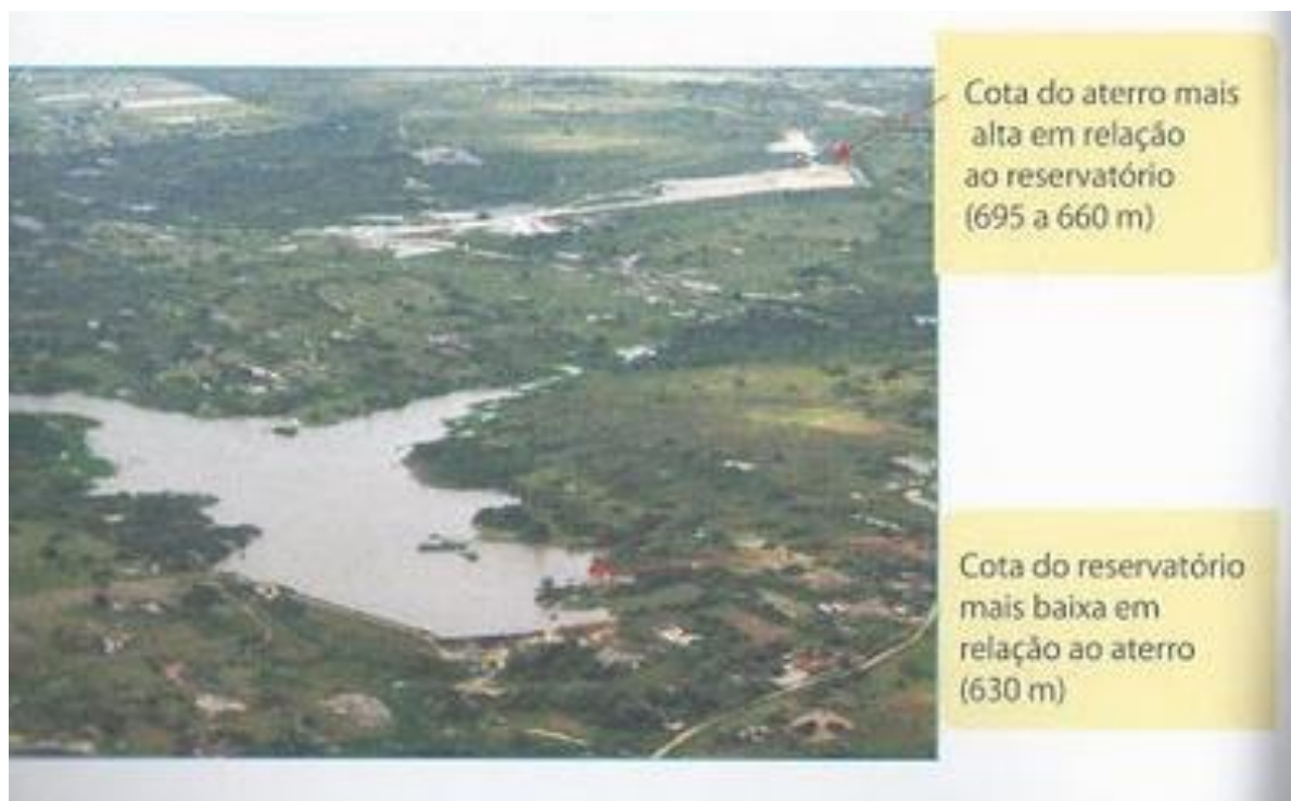
Foto 6 – Reservatório do Sítio Açudinho e Aterro Sanitário.
