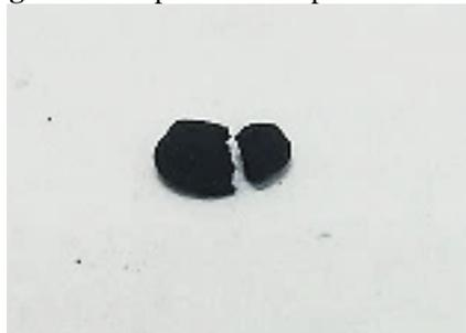
Conforme a temperatura do tratamento térmico aumentou, mais carbono amorfo foi depositado no material, promovendo um maior grau de densificação, conferindo maior resistência aos compósitos Fe-C850 e Fe-C900. O compósito Fe-C900 apresentou melhor resistência, tendo sofrido o menor encolhimento, 17,2%, o que também pode estar relacionado ao maior grau de grafitação deste material, como verificado anteriormente. Os dados obtidos no ensaio são apresentados na **Tabela 8**.
