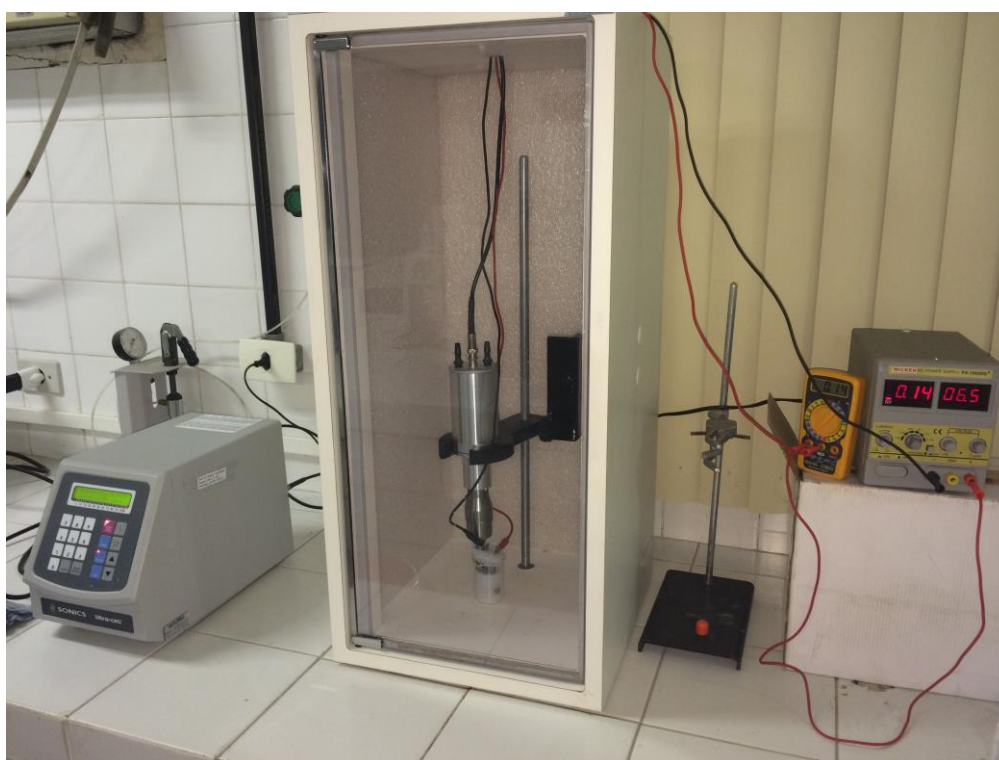
Figura 6 - Sistema montado para síntese sonoeletroquímica da MOF [\text{Zn}_2(1,3\text{-bdc})(\text{bzim})_2]_n
