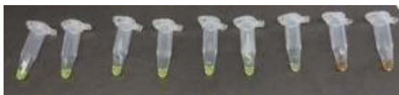
Figura 7—Os tubos após a reação LAMP com SYBR Green. As amostras positivas ficam verdes e os negativos ficam laranja.
