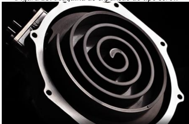
Figura 18: Máquina de expansão do tipo scroll
