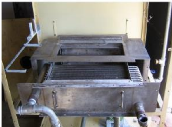
Figura 19: Trocador de calor compacto (Recuperador de calor do COGENCASA)
