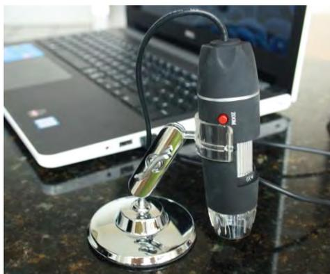
**Figura 53** - Microscópio digital utilizado nas análises. Fonte: Acervo da autora.
