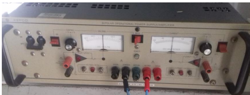
Figura 24 – Fonte de tensão bipolar KEPCO utilizada nos experimentos.
