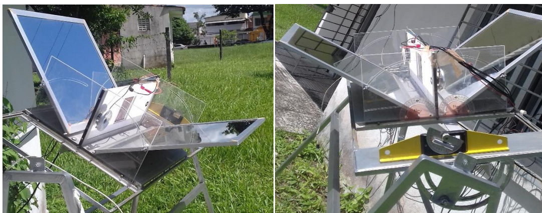
Figura 33 – Esquema do ensaio de iluminação simultânea com o V-trough .
