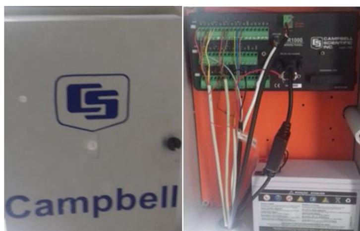
Figura 25 – Datalogger Campbell utilizado para o armazenamento de dados.
