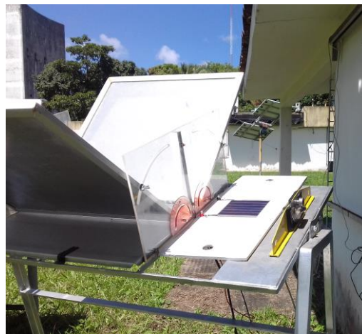
Figura 31 – Condições do ensaio para obtenção da transmitância do módulo OPV em diferentes inclinações.
