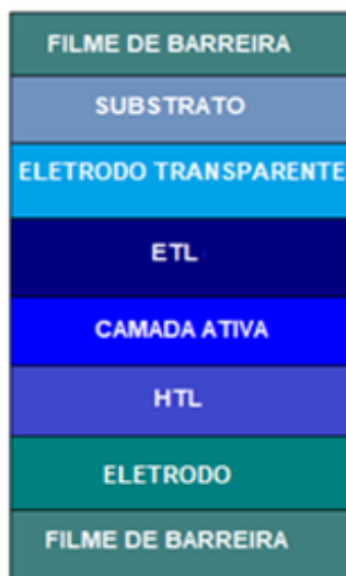
Figura 29 – Camadas do módulo OPV utilizadas no modelo.
