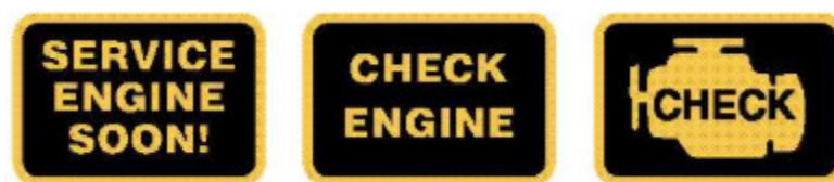
Figura 1 – Lâmpada indicadora de mau funcionamento utilizada nos painéis de instrumentos dos veículos para alertar avarias no motor.
