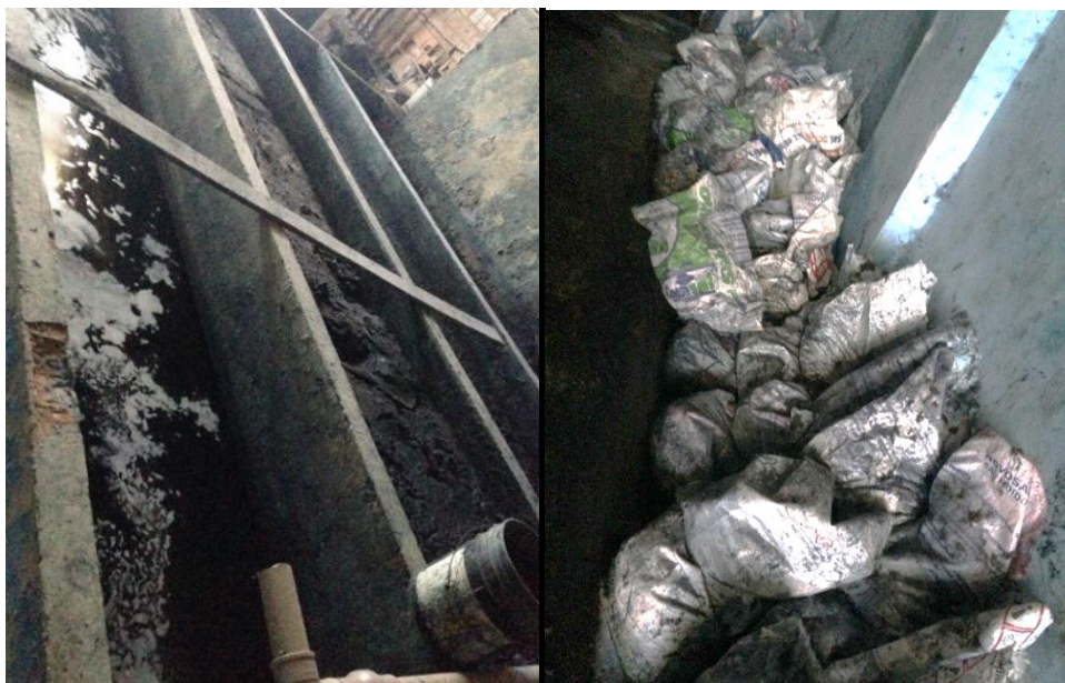
Figura 11 - Lodo têxtil gerado - Empresa 2.
