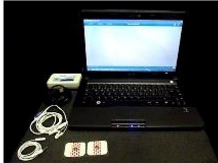
Figura 13: Eletromiógrafo, sensores, cabos, eletrodos e notebook utilizados para aquisição do exame eletromiográfico.
