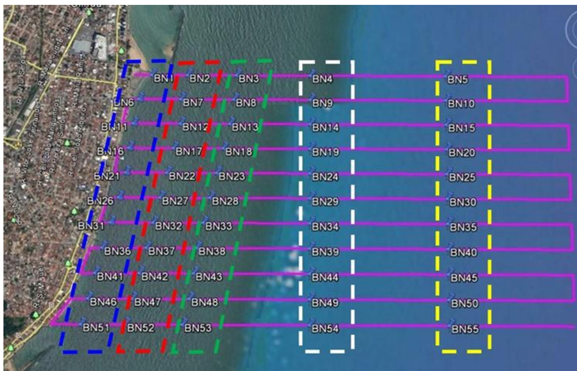
Figura 114 – Localização dos pontos de coletas das amostras da plataforma continental adjacente à praia de Bairro Novo, conforme afastamento em relação à costa.
