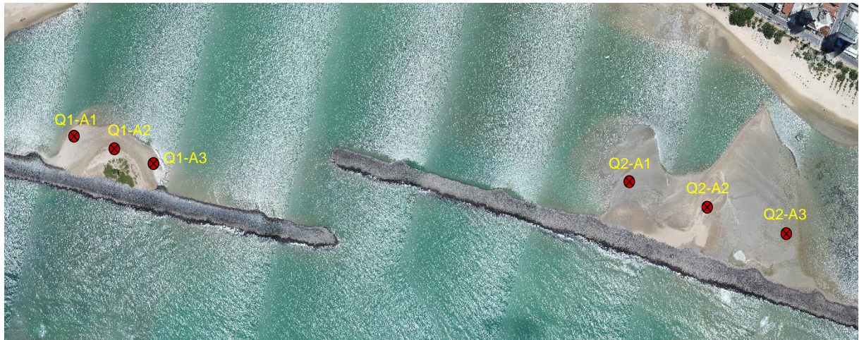
Figura 123 – Pontos de coleta das amostras de sedimentos nos quebra-mares da praia de Casa Caiada, Olinda-PE.
