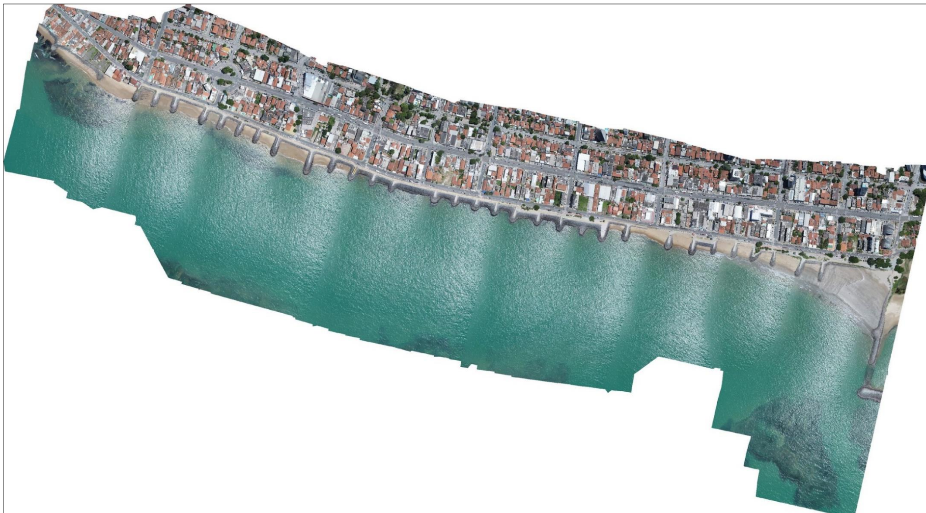
Figura 18 – Aerofotogrametria das células formadas pela bateria de espigões que se separam pela presença do enrocamentos na Praia de Bairro Novo, Olinda-PE.
