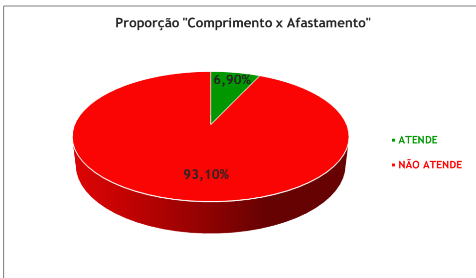
Figura 158 – Relação de proporção “Comprimento x Afastamento” dos espigões da praia de Bairro Novo, Olinda-PE.
