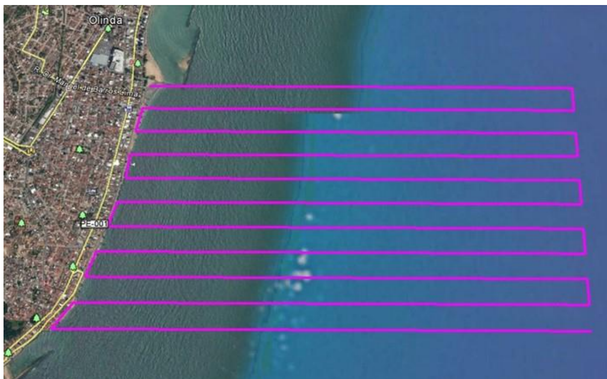
Figura 86 – Malha de implantação dos perfis no levantamento batimétrico da plataforma adjacente à praia de Bairro Novo, Olinda-PE.
