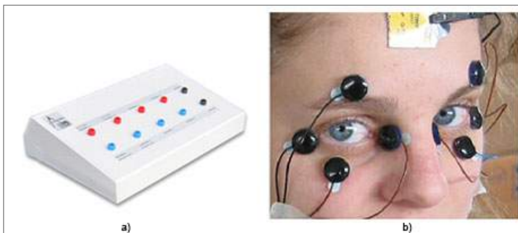
Figura 7 - a) Controles para a impedância do eletrodo; b) Usuário utiliza RO baseado em eletro-oculografia.
