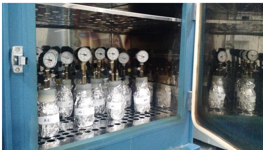
Figura 14 - Reatores do ensaio BMP acondicionados em estufa
