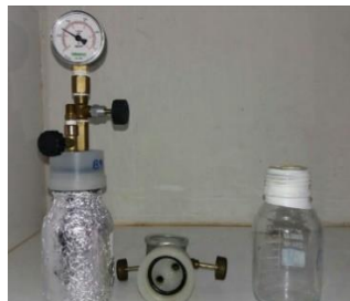
Figura 13 - Reator utilizado no ensaio BMP
