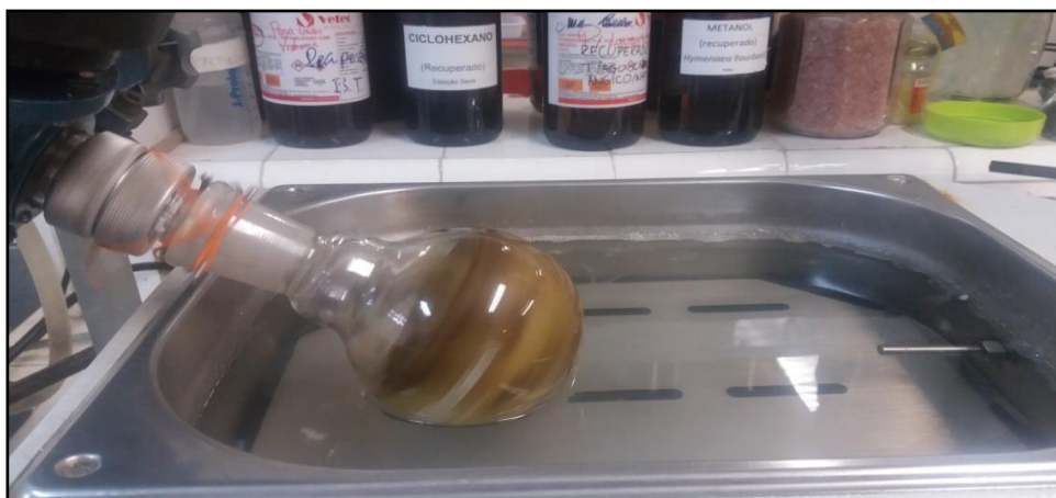
Figura 03 - Evaporação do solvente por rotaevaporador
