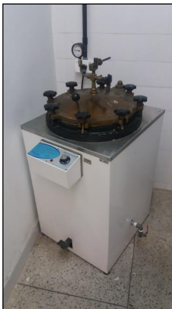
Figura 12 - Autoclave para esterilização dos meios de cultura
