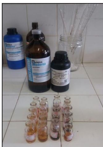
Figura 07 - Amostras de Neossolos Quartzarênicos submetidas ao Cloreto de Ferro III
