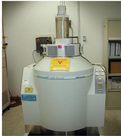
Figura 4: Irradiador Gammacell com fonte ^{60}\text{Co} .
