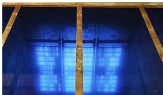
Figura 3: Fonte de ^{60}\text{Co} (Cobalto -60) submersa na piscina.
