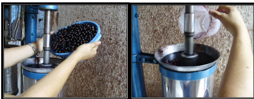
Foto 24 - Colocação do fruto na máquina e adicionando água Produção da autora (2009)
