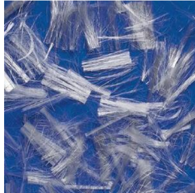
Figura 63: Exemplo de aditivos em fibra (nesse caso polipropileno) adicionado à pasta cimentícia para diminuir a retração
