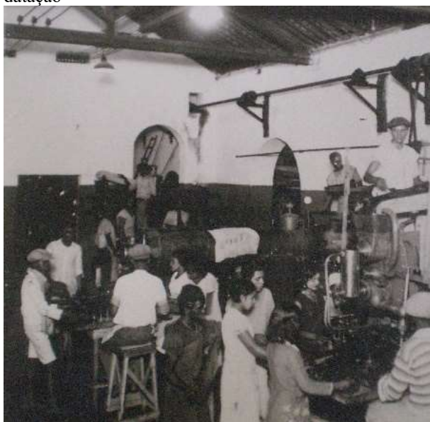
Imagem 30 - No primeiro plano o produto sendo enlatado na enchedeira e no segundo plano as embalagens sendo fechados na reclavadeira, sem datação
