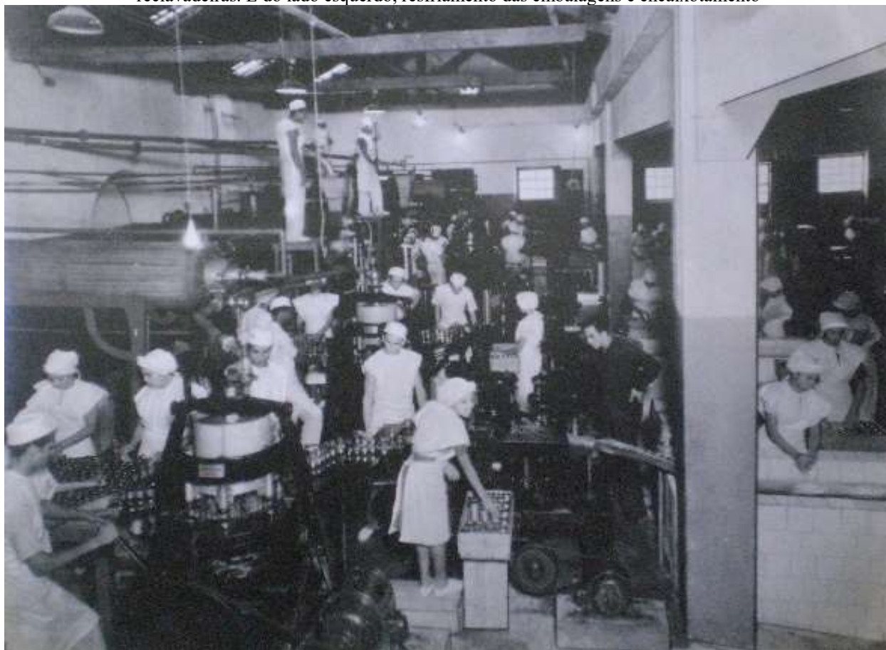
Imagem 48 - Processo de produção dos produtos Peixe: ao fundo (lado direito) as enchedeiras. No centro, as reclavadeiras. E do lado esquerdo, resfriamento das embalagens e encaixotamento
