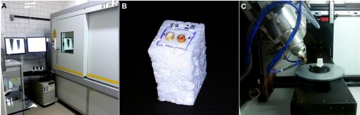
**Figura 2.** Escaneamentos de micro-CT. (A) Tomógrafo modelo XTH225ST. (B) Espécimes inseridos no bloco de isopor. (C) Bloco de isopor acomodado na plataforma rotatória do sistema de micro-CT.
