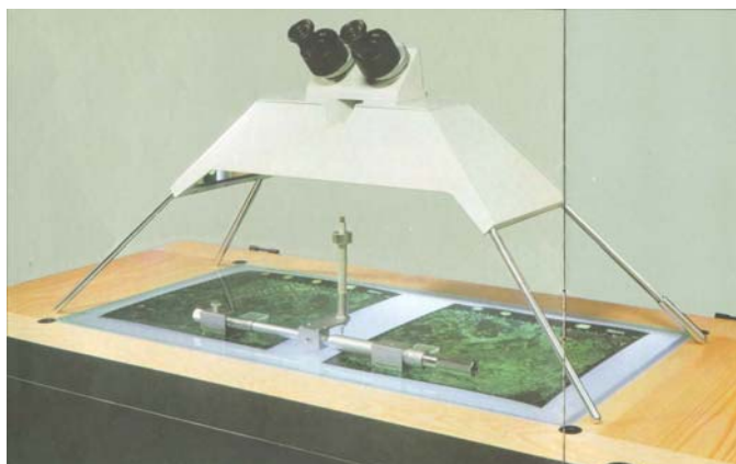
Figura 13: Estereoscópio de reflexão ou de espelhos
