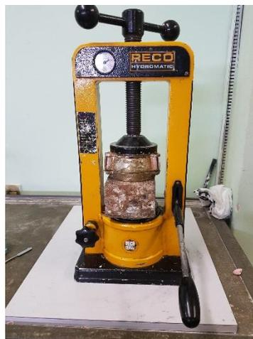
Fig. 08. Prensagem de resina termopolimerizável em mufla metálica
