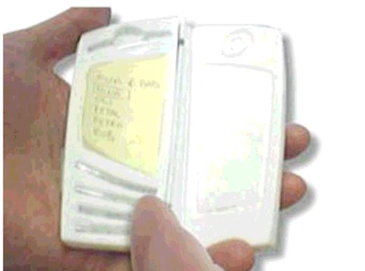
Figura (51) "soft" mockup desenvolvido tridimensionalmente apenas com uso de papel (fonte: Gill, 2005)
