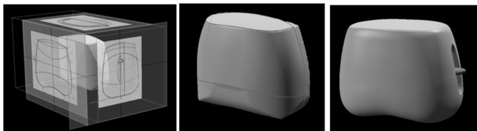
Figura (44). Imagens dos sketches2D colocados nos planos do ambiente de prototipagem virtual 3D, Figura (45) Protótipo virtual em um estado preliminar, Figura (46) forma final precisa usando equipamento de realidade virtual Free Form/ Phantom (fonte: Evans, 2005).
