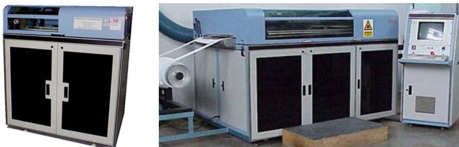
figura (65) e (66) máquinas de prototipagem rápida LOM 1015 e LOM 2030 (fonte: Warwick Manufacturing Group e Departamento de Engenharia Mecânica e Nuclear da Universidade do Estado da Pensilvania)
