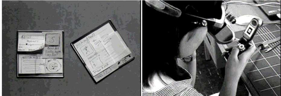
Figuras (87) e (88) Exemplos de protótipos de baixa e alta fidelidade usados para o desenvolvimento de telefone móvel (Nam e Lee, 2003)
