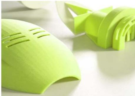
Podemos definir esse tipo de protótipo como a representação de um produto em escala natural (1:1) impresso fisicamente a partir de protótipos virtuais feitos em (CAD) através de máquinas de prototipagem rápida (com tecnologia CNC).
