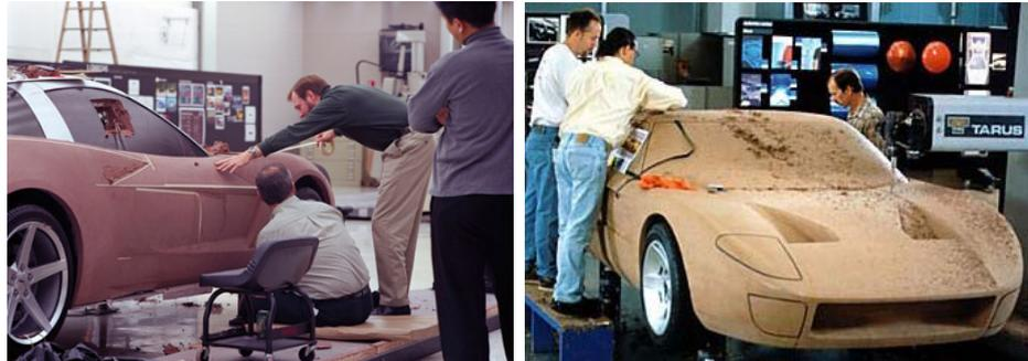
Figura (55). Designers da Chevrolet desenvolvendo um mockup de média fidelidade do Corvette através da técnica das 10 linhas (usada para transferir o Sketck para a forma tridimensional) Figura (56) Mockup impresso por fresadoras através de prototipagem rápida (ver item a seguir) sendo ajustado manualmente por designers (fontes: Car design Online).
