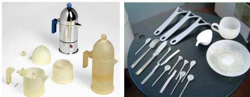
figura (76) Peças prototipadas de uma cafeteira da Alessis. Figura (77) peças prototipados pela máquina Invision facilitam a comunicação entre os grupo de designers internacionais da Alessis e a fábrica na Itália (fonte: Revista prototype magazine, 2006).
