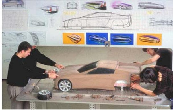
figura (31) Designers da GM usando um modelo em escala 1:4 para esculpir e visualizar a forma e a proporção de um automóvel (fonte: Car Design Online).
