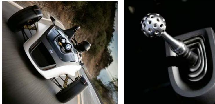
figura (85) sistema inovador de troca de marcha desenvolvido pela Wolkwagem auxiliados pela tecnologia da EOS de impressão direta através de sinterização de metal (fonte: Revista prototype magazine, 2006).
